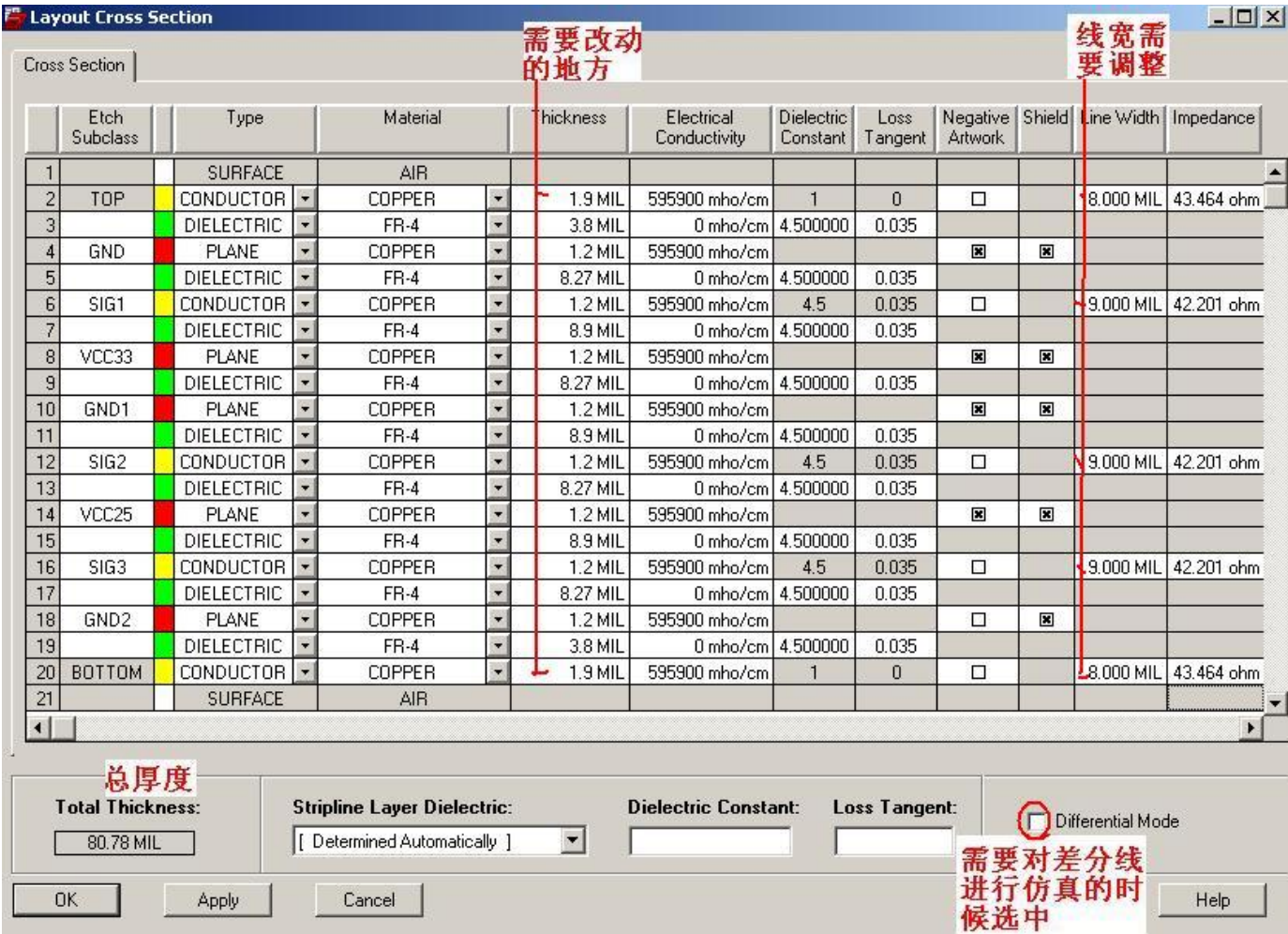
图2-4 Layout Cross Section 特征阻抗设置窗口
