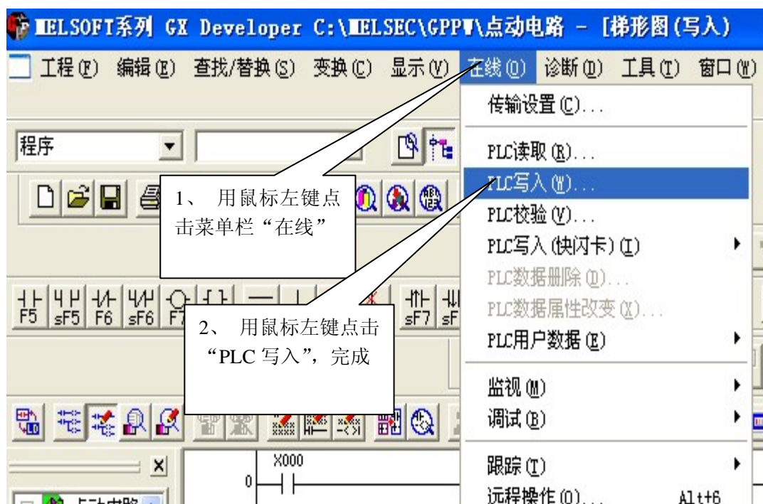
图 4-26 将计算机已编译程序写入 PLC
