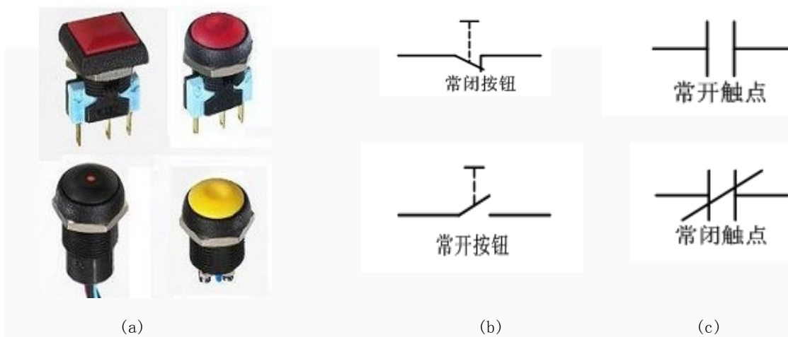
图 1-1 按钮开关示意图
