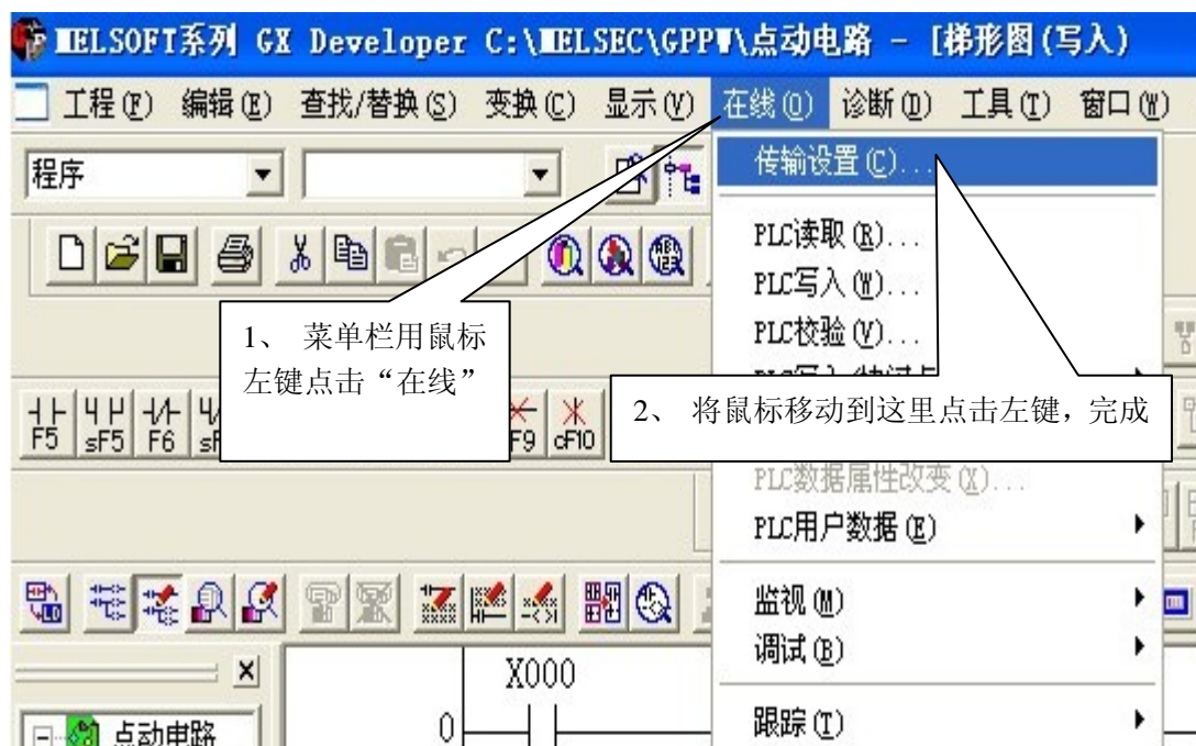
图 4-24 设置 PLC 与计算机连接 COM 口
