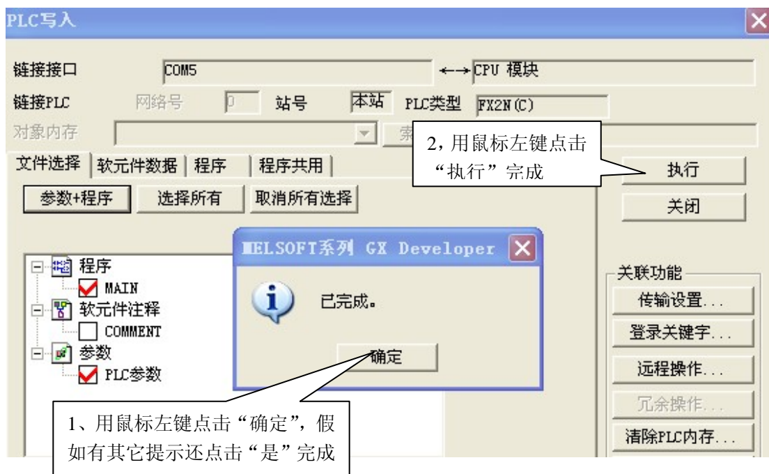
图 4-29 将计算机已编译程序写入 PLC
