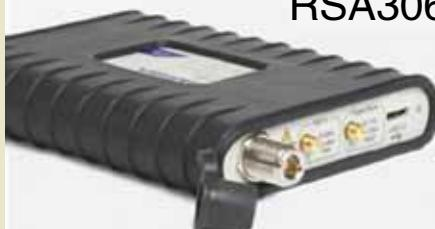
全新 RSA306 频谱分析仪，身材虽小，却功能强劲。它拥有两倍尺寸、两倍价格的频谱分析仪中预计提供的各种功能 \*\*，包括实时结构和已获专利的 DPX® 技术。
