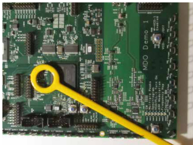
图 2：使用近场探头，发现干扰信号的峰值位置。
