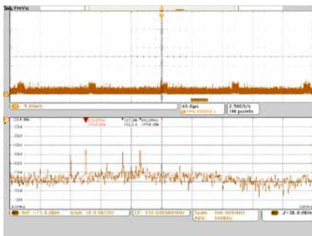
图 5: 频谱时间指示符在 RF 突发之间移动。在这个时间位置，137MHz 信号电平低 ~12dB。
