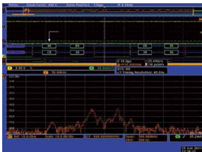
图 16. 通过 SPI 总线捕获寄存器状态数据
