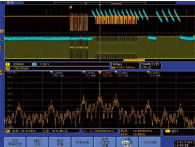
图 15. Rx 信号与射频信号的时序关系
