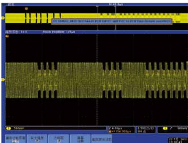
图 8. 测量 PCD 发射信号与标签返回信号间的延迟时间
