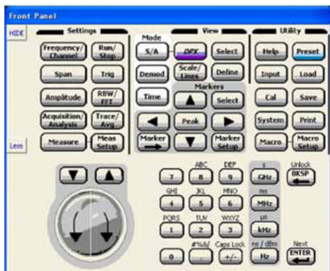
图 8. RSAVu 软前面板可以简便地离线访问进行设置和控制。
