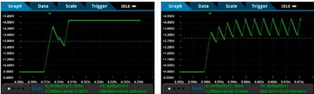
降压转换器上的开机异常事件，输出电压暂降（左）和永久开机失败（右）。
