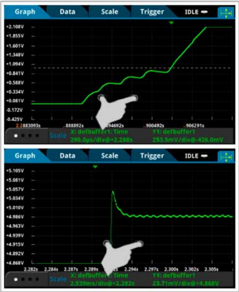
卷动和放大软启动行为（上）以及到达稳定状态前的输出电压过冲（下）。
