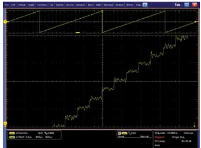
图 21. 同一高分辨率斜坡信号放大后的画面，基于大量的平均，显示垂直分辨率明显高得多。
