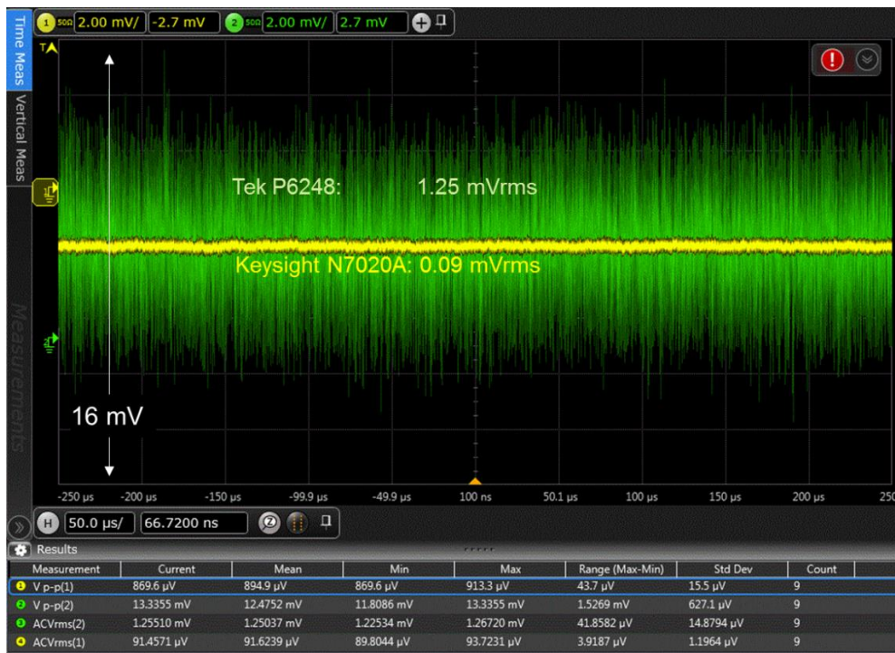
图 2. 探头噪声添加到示波器噪声上。屏幕上显示的是电源轨测量可能使用的两个不同探头的噪声。Tek P6248 探头的噪声是 Keysight 7020 电源轨探头的 10 倍。
