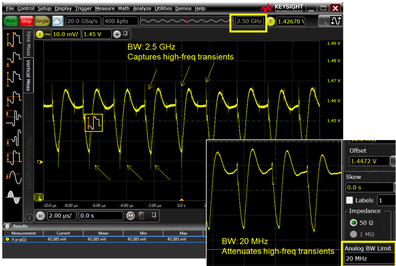
图 3 显示了 2.5 GHz 带宽的电源轨测量和另一个带宽限制为 20 MHz 的电源轨测量。在高带宽下，您可以清晰地看到高频干扰，但是在打开 20 MHz 带宽限制后就看不到了。
