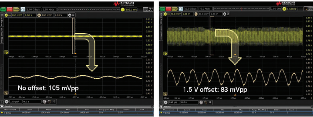
图 4. 一个 1.5 V 电源在无偏置 / 有探头偏置时的噪声测量结果
