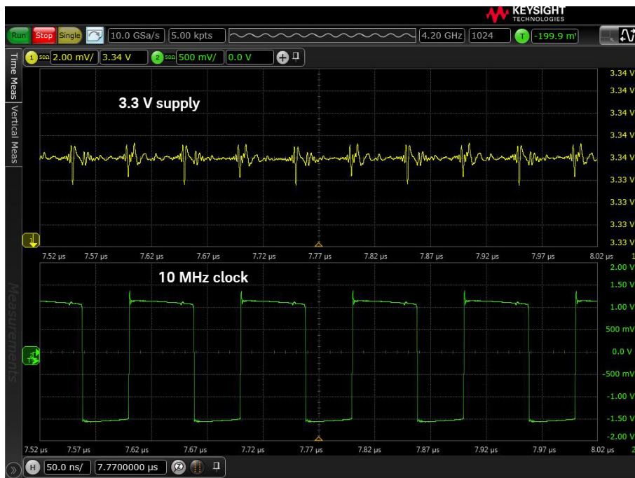
图 11. 触发这个 10 MHz 时钟并打开平均值功能，可以消除所有随机噪声以及与时钟不相干的信号。所生成的视图显示了与 10 MHz 时钟相关的电源噪声。
