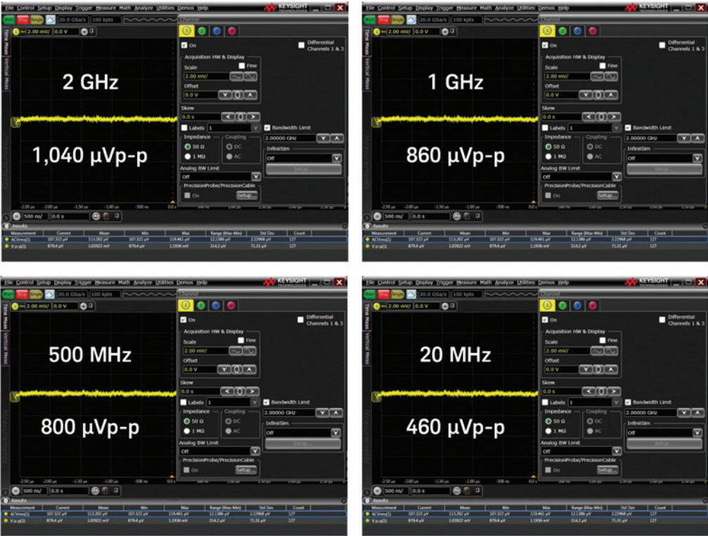
图 2. 使用 N7020A 电源探头和 S 系列示波器在不同带宽限制条件下测量基线噪声
