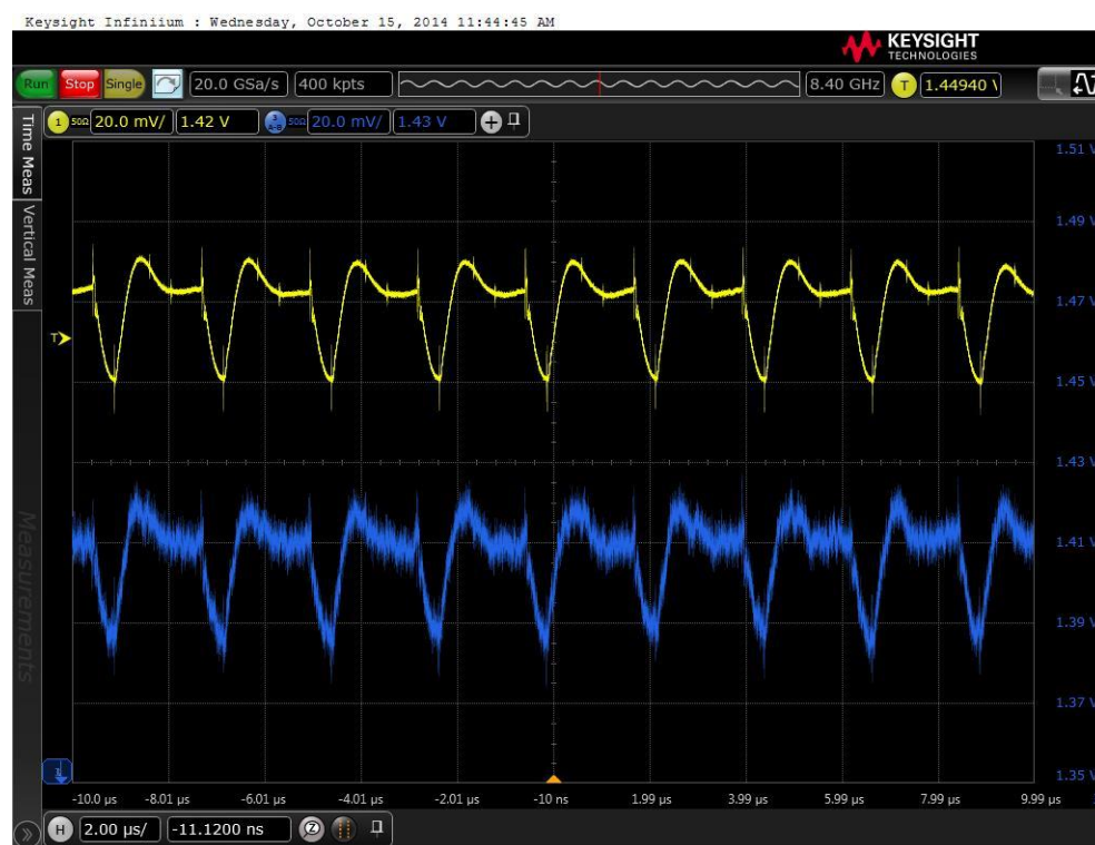
图 3 开关电源输出比较 = 黄色：1:1 探头，蓝色：2:1 探头
