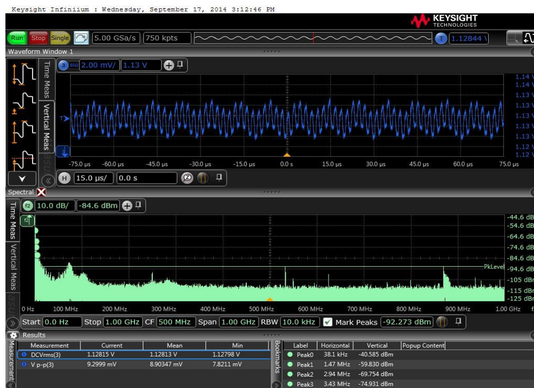
图 5 使用 FFT 可以更深入地分析捕获到的噪声信号。
