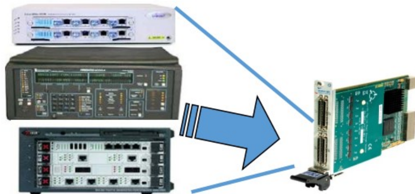
图 1 一个 FPGA 板卡可以替代多台仪器
