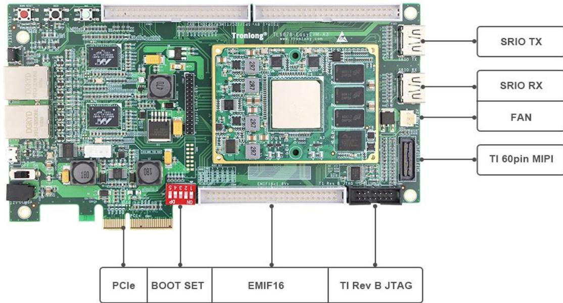
图 9 开发板硬件资源图解 2
