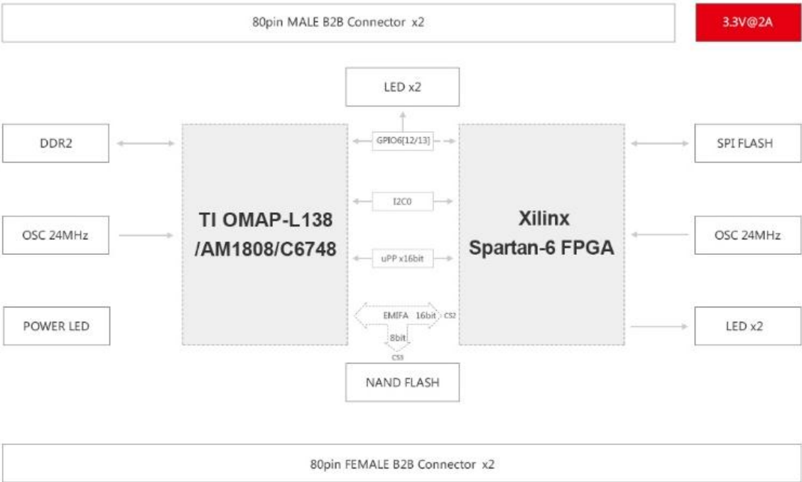
图 4 核心板硬件框图
