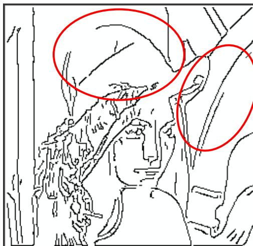
用固定阈值在二阶尺度提取的边缘
