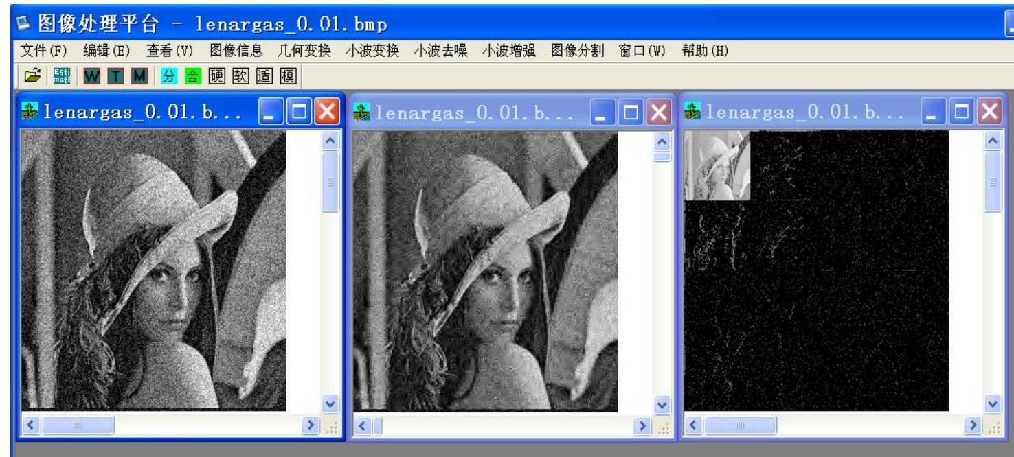
使用2尺度sym8滤波器分解的小波系数进行硬阈值去噪
