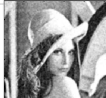
原始图像 添加了方差为0.4的高斯噪声的图像 高频系数置零法恢复的图像
