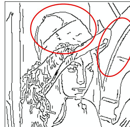
用自适应阈值在二阶尺度提取的边缘
