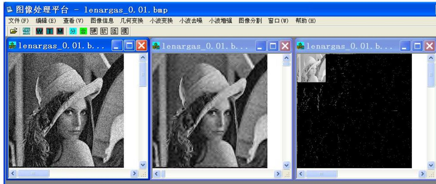
使用2尺度sym8滤波器分解的小波系数进行自适应阈值去噪
