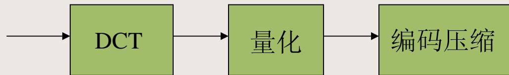
DCT:  $8 \times 8$ 块做DCT变换,统计分析表明, 图象局域相关性较强。
