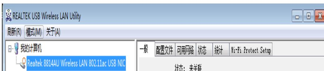
从模式选项中，有基站和接入点两种可选，其实基站就是最传统的无线网卡功能(接收前端 AP 的热点)，而接入点就是 Soft AP 了(提供 SSID 热点)。
