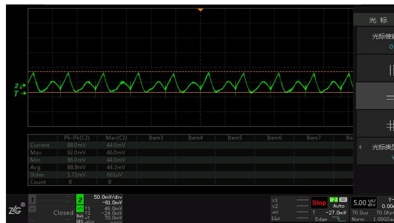
VIN=24V VOUT=5V 3.1A 负载 纹波=88mV
