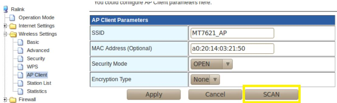
B. 填入需要连接 AP 的 SSID 和 Security。点击“Apply”。
