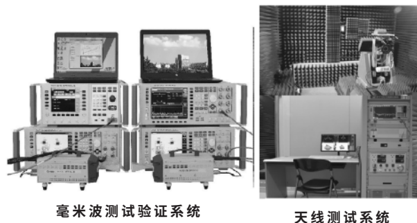
图 11 5G 毫米波测试验证与天线测试系统
