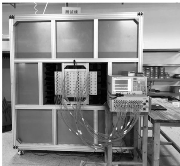
图7 产线测试平面波模拟器北航 PWG-63
