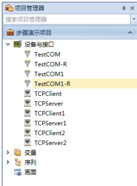
同时，设备适配器还可以通过插件的方式，让用户扩展新的设备和接口，例如监听型串口、监听型网口等，以满足特殊的连接需求。
