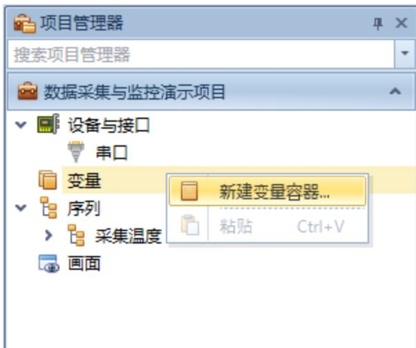
弹出新建变量容器对话框中，填写“名称”，点击“确定”。
