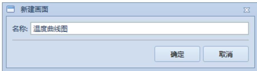
在项目管理器中选择新创建的“温度曲线图”节点，然后双击鼠标左键，或者点击鼠标右键，在弹出菜单中选择“编辑...”，打开画面编辑页面。
