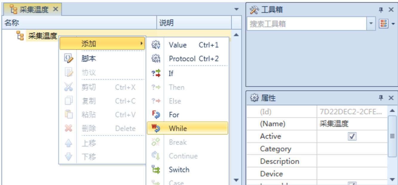
接下来，添加发送采集命令，选中“While”节点，单击鼠标右键，在弹出菜单中选择“添加 → Protocol”，添加协议类型步骤，然后在属性面板，修改步骤名称“(Name)”为“采集命令.request”，TransceiveMode 设置为 Send，表示主动发送，Device 属性选择名称为“串口”的设备。
