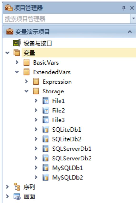
软件内置变量编辑器，用户可以很方便的创建和编辑各种类型的变量。
