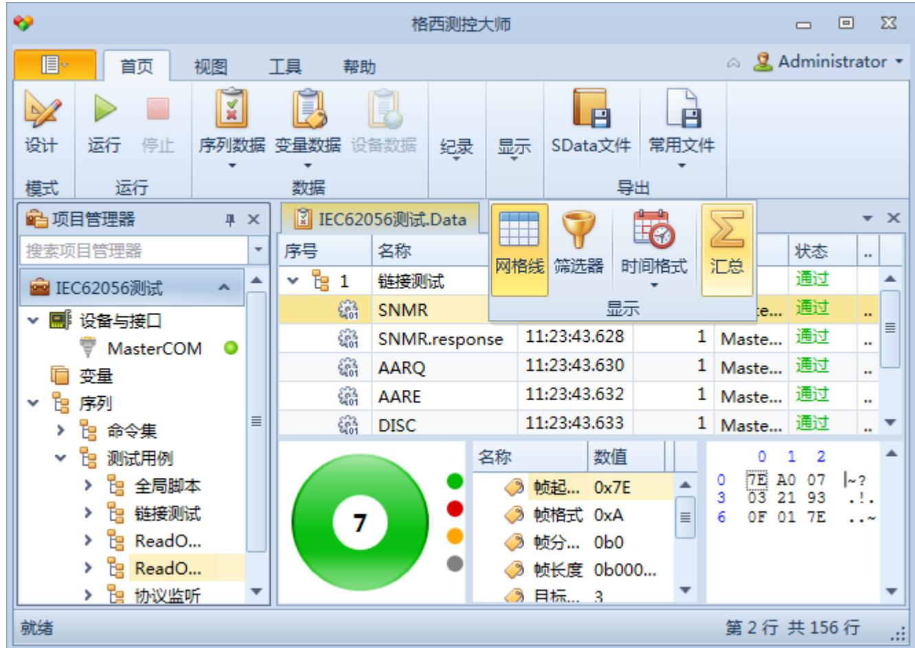
点击工具栏的“显示”→“汇总”，可以切换到汇总页面，分类统计步骤的执行信息，如图所示。
