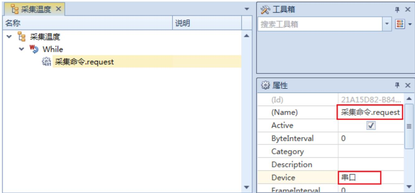
接下来，编辑发送采集命令的协议数据，选中“采集命令.request”节点，单击工具栏的“协议”按钮，打开协议编辑界面，通过单击鼠标右键，在弹出菜单中选择“添加 → 协议字段”，依次按以下属性表添加协议字段。
