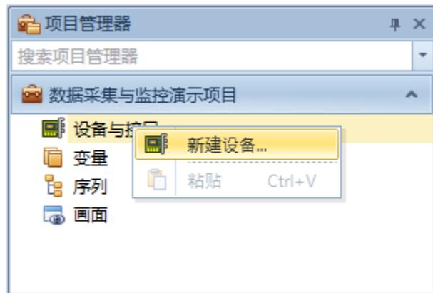
弹出新设备对话框中，选择“串口”，点击“确定”。
