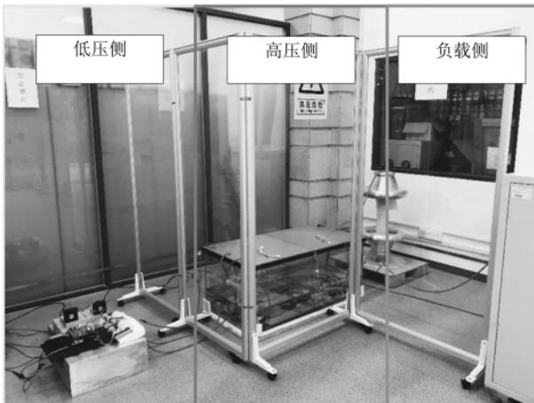
图6 超高压直流变换器功率实验平台
