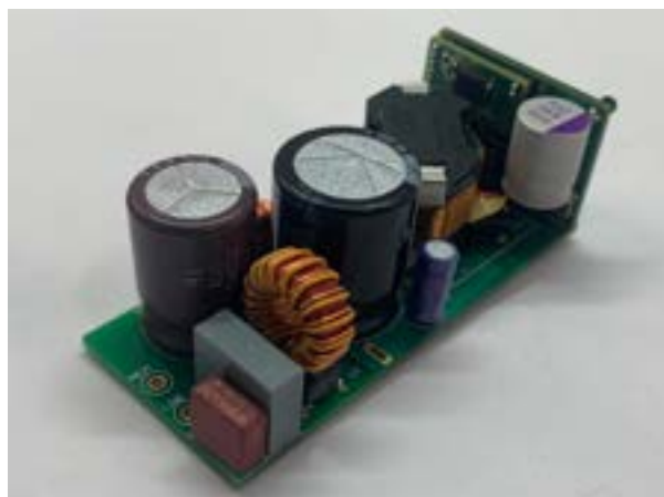
图 2. 尺寸为 65mm x 28mm x 25mm 的 65W 有源钳位反激式转换器。
