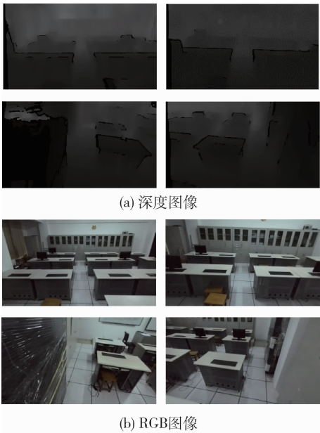
图 5 ZED 双目相机输出图像
