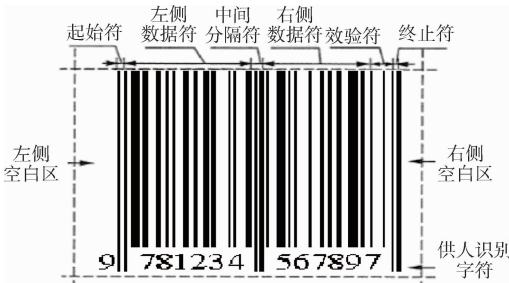
图 1 EAN-13 码的结构
