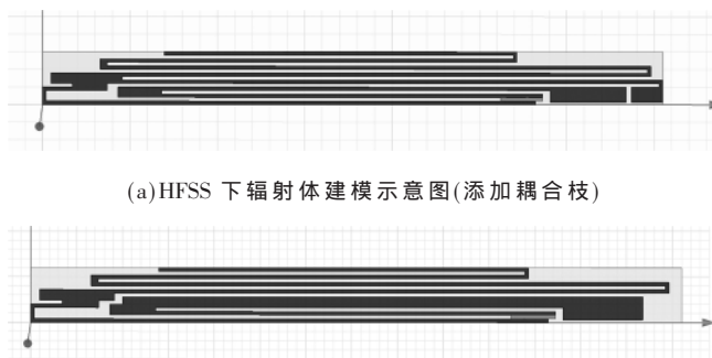
(b) HFSS 下辐射体建模示意图(未加耦合枝)
