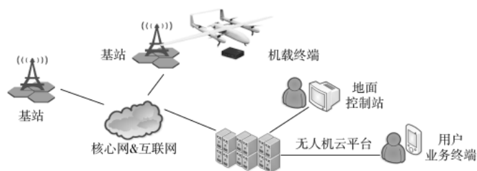
图1 基于蜂窝移动通信网络的低空网联无人机系统架构
