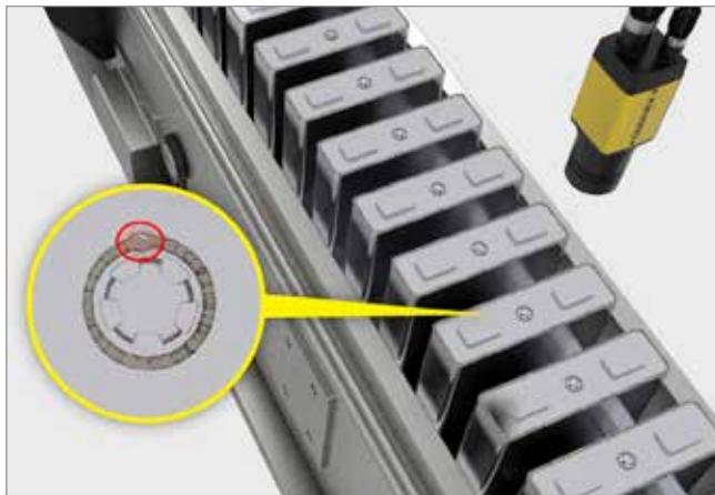
康耐视深度学习软件与3D激光位移传感器搭配使用可以检测焊接缺陷，并验证密封销是否正确放置。
