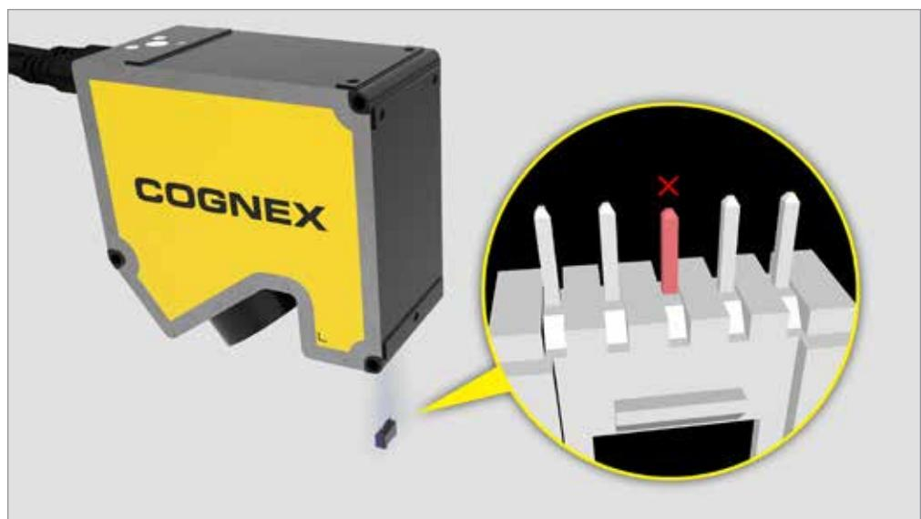
3D激光位移传感器能够可靠地检测连接件引脚，以确保所生产的连接件符合严格的公差范围，从而优化产品质量。
