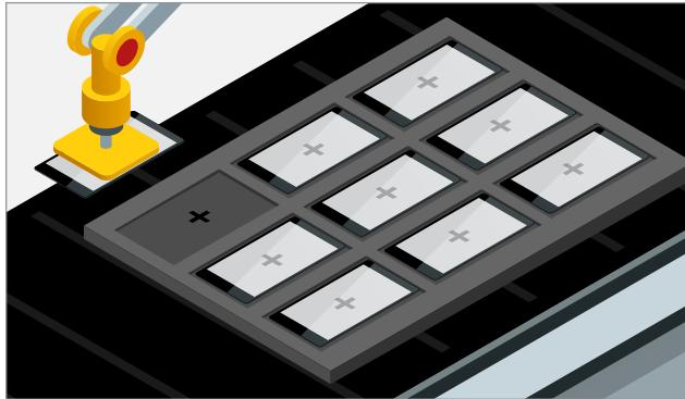
视觉引导的机器人（VGR）能够处理复杂的对位，在面板生产和层压环节提供独立的机器照看功能。
