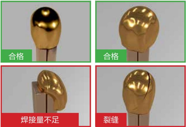
康耐视深度学习软件的缺陷检测和分类工具能够识别出所有不可接受的缺陷，并将它们进行分类，以实现上游流程控制。
