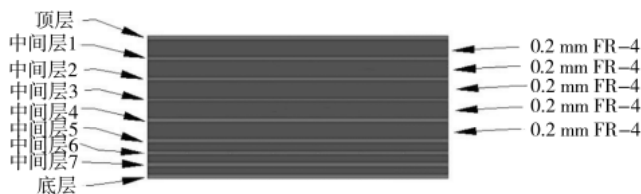
图8 复合多层板层叠结构
