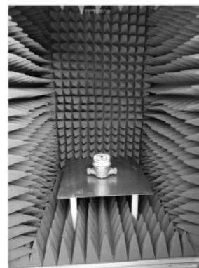
图11 放入干式水表的标签天线测试场景
