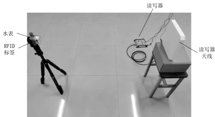
图9 标签天线的距离测试场景
