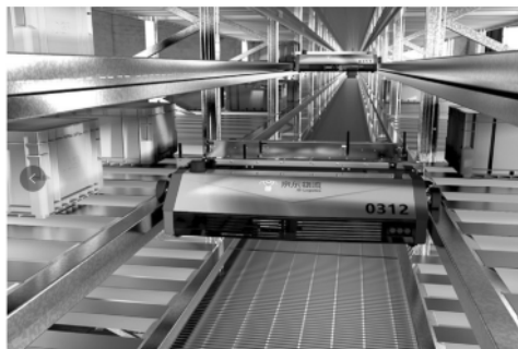
图 1 典型的 AGV 和穿梭车示意图
