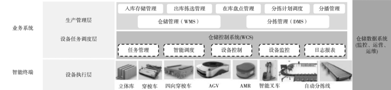
图 3 智能仓储的软件架构示意图
