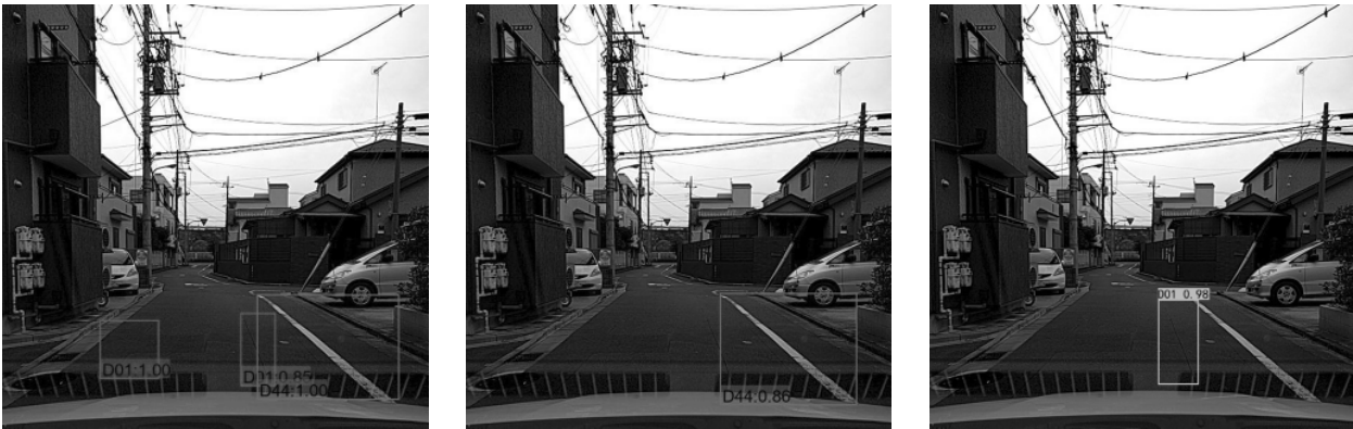
图 7 改进的 DSSD(左)、SSD(中)、YOLO(右)算法结果对比
