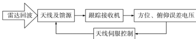
图2 伺服系统闭环反馈
