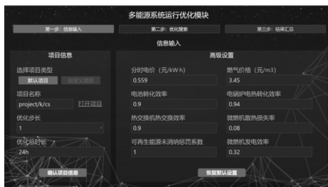
图9 多能源系统运行优化模块的信息输入界面
