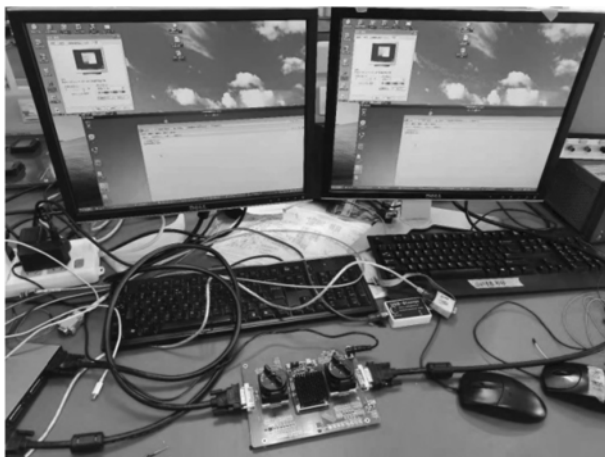
图 7 本芯片与市面上某款 DVI 发送芯片之间的级联通信
