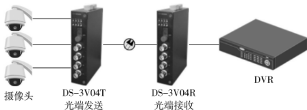
图 6 模拟视频信号光端收发机信号传输过程
