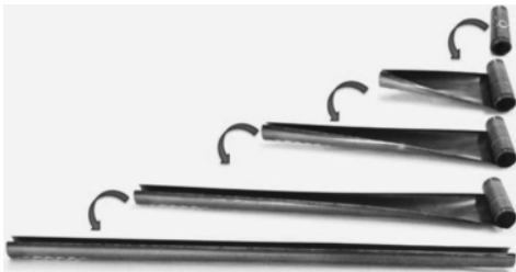
图8 C形薄壁式伸展杆卷绕及展开状态图 [9]
