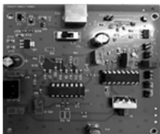
图7 电子线路板调制电压产生电路
