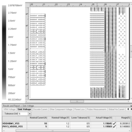
图 22 HBM 接口电源直流压降仿真
