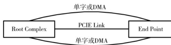
图 5 PCIE 部分设计框图
