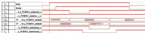
图8 PCI9054写操作实测时序图
