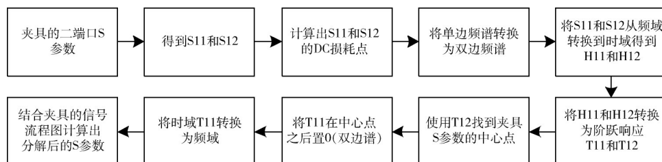
图3 二端口 S 参数分解算法的具体流程图
