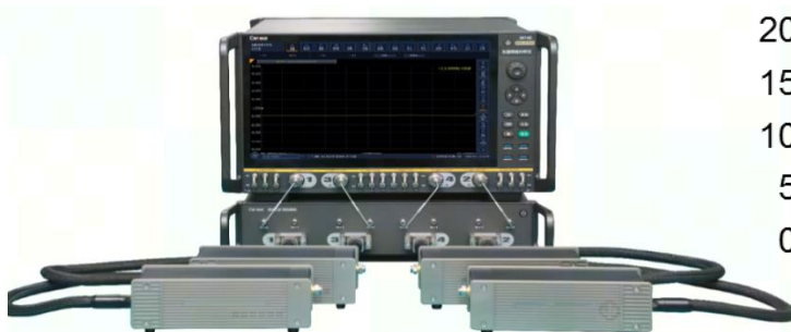
扩频系统方案：主机+控制机+扩频模块
